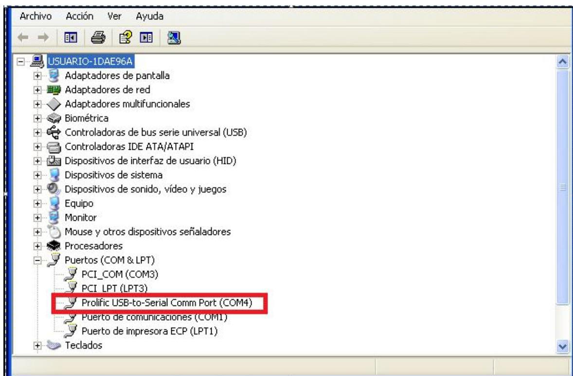
Cuando el datafono tiene convertidor a USB se debe configurar el puerto
